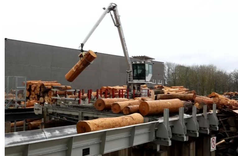
Tri par diamètre et longueur après écorçage et tronçonnage
