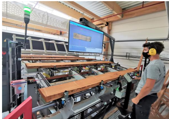
Scan de forme pour rectification du galbe
