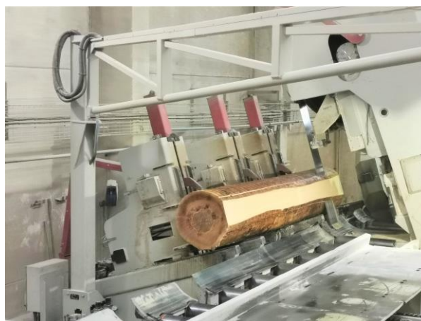
Sciage en planches (scie à ruban double sens)
