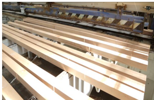
Barres aboutées en sortie de presse
