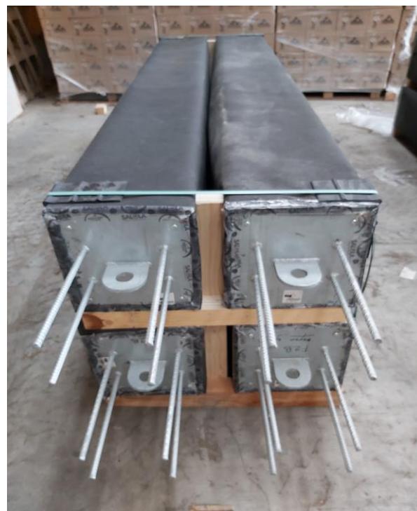
Protection et colisage spécifique pour stockage et levage sur chantier
