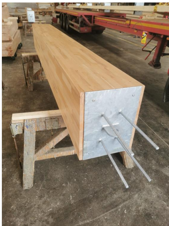
Pose des ferrures avec crochet de levage intégré
